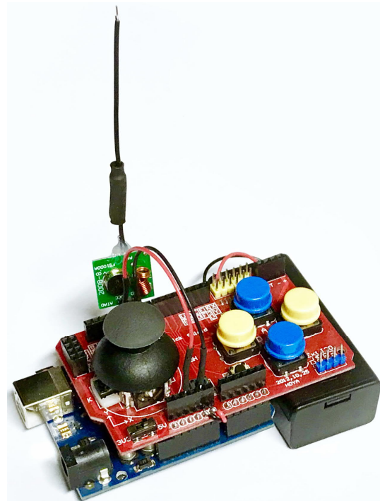
Abb. 2: Fernsteuerung mit Arduino, Joystick Shield, Sendemodul und Batteriehalter
