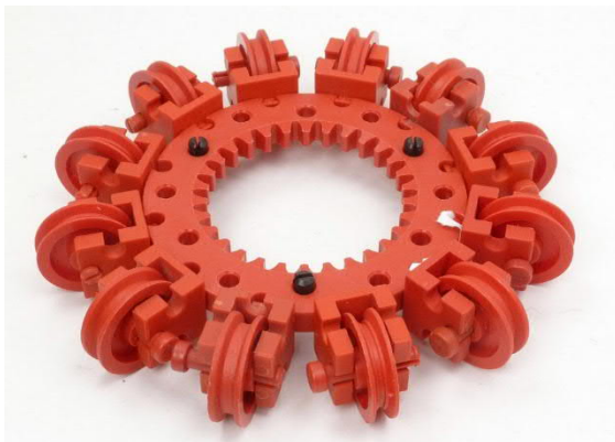
Abb. 20: Omniwheel, 12 Seilrollen (2021, Foto: Thomas Püttmann)
