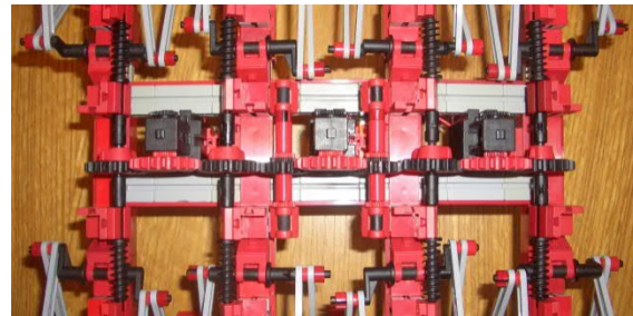
Abb. 7: Detail der Motorisierung des Strandbeests aus Abb. 5.
