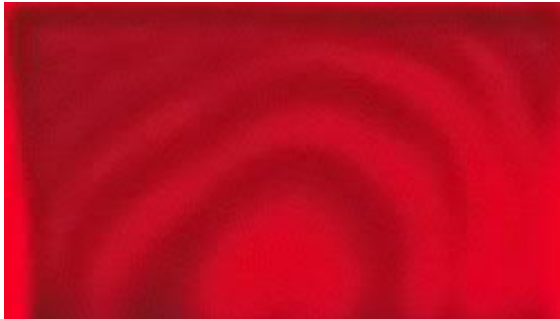
Abb. 6: Interferenzbild einer roten LED
