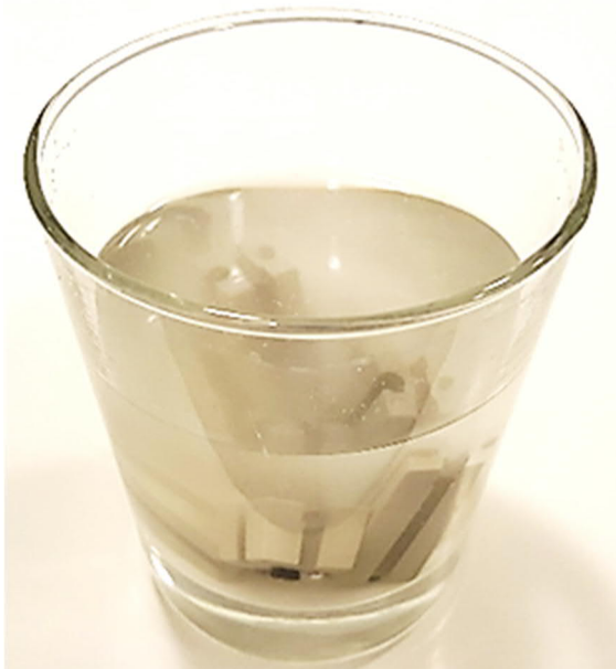
Abb. 9: Bausteinlagerung in Kaisernatron
