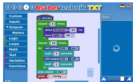
Abb. 7: Brickly-IDE – Blockly für die TXT-Community-Firmware, erschienen 2016
