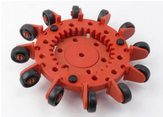
Abb. 19: Omniwheel, 12 V-Räder 14 (2021, Foto: Thomas Püttmann)
