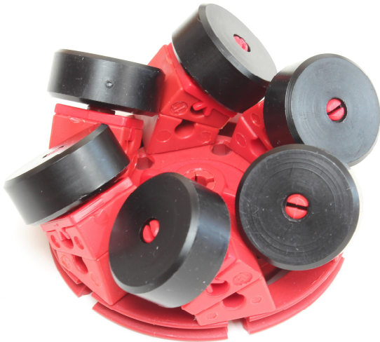
Abb. 7: fischertechnik-Mecanum-Rad mit V-Rädern 23 (2020)
