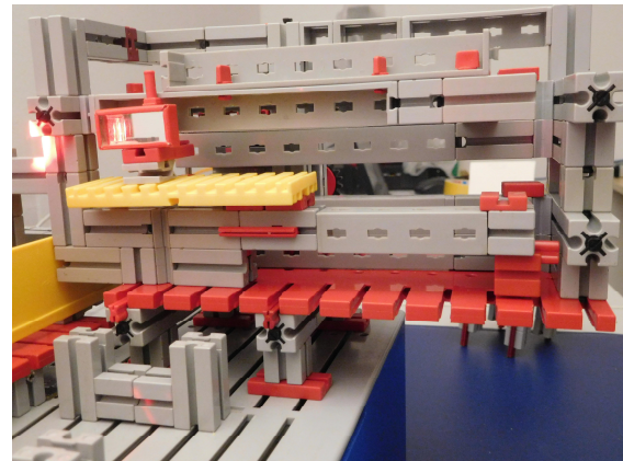
Abb. 4 zeigt die Verstelleinheit von vorne. Man erkennt zwei Verstellebenen: die untere für die horizontale Ausrichtung, die obere für die vertikale
