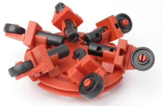
Abb. 9: Mecanum-Rad mit exakter 45°-Lage der Rollenachsen (2021)
