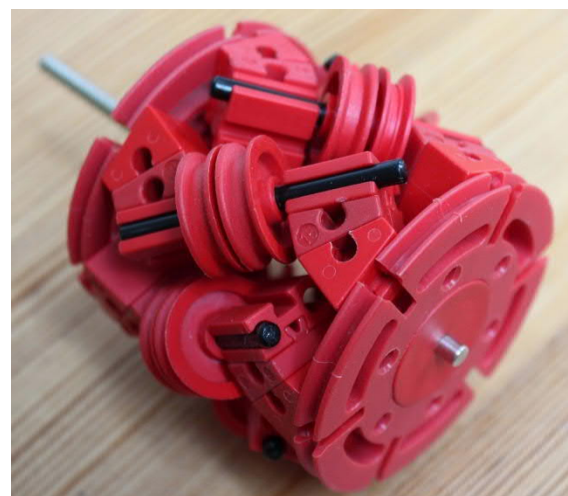
Abb. 6: Mecanum-Rad mit zwei Drehscheiben 60 (2014)
