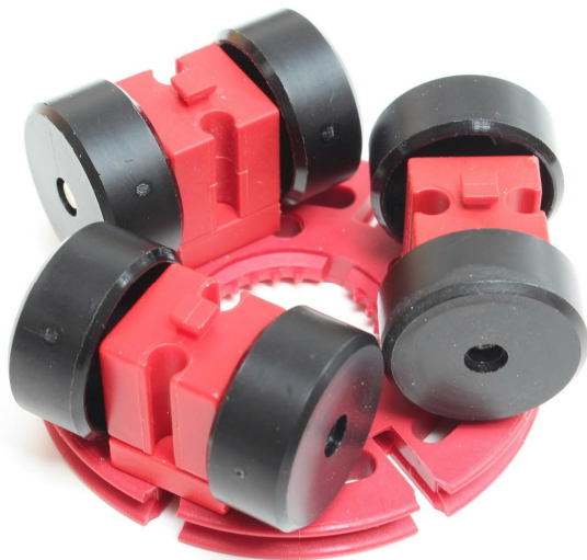
Abb. 17: Omniwheel, sechs V-Räder 23 (2020)
