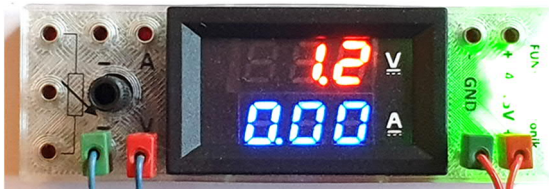
Abb. 3: V-A-Meter: Spannung wird in roten und Strom in blauen Ziffern angezeigt
