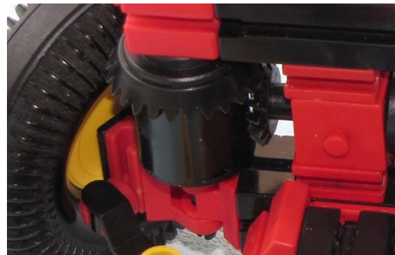
Abb. 12: Differenzialkäfig treibt Reifen 60
