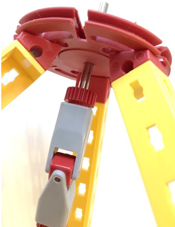
Abb. 2: Die obere Aufhängung des Pendels in einer locker angezogenen Flachnabe
