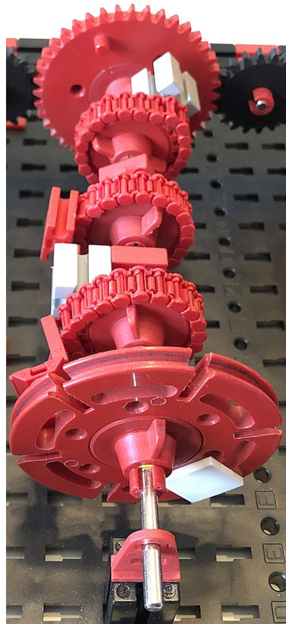
Abb. 25: Die Z20-Variante von der Abtriebsseite gesehen
