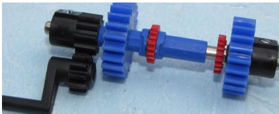
Abb. 9: Zahnräder von Eitech mit Modul 1
