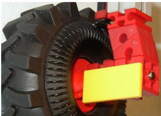
Abb. 16: Bearbeiteter Reifen 60 dreht Traktorreifen 80
