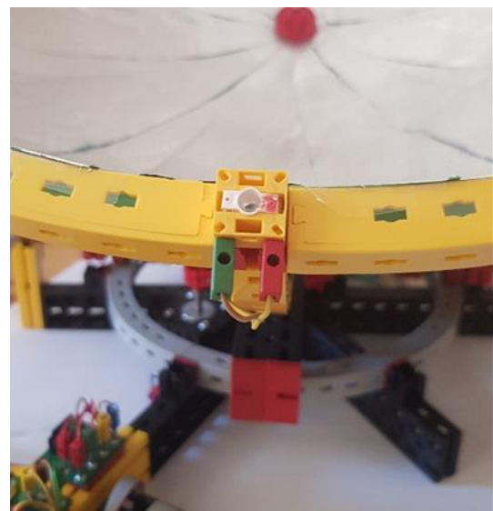
Abb. 10: Mit vier Fototransistoren richtet der TXT den Solarkocher auf die Sonne aus.
