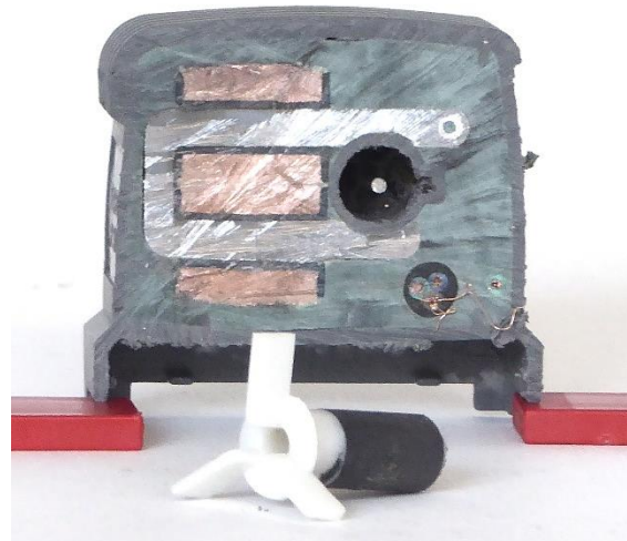
Abb. 13: Pumpenrad und zweipoliger Dauermagnet
