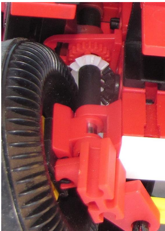
Abb. 11: Rastkegelzahnrad auf Differenzialkegelrad auf Reifen 60
