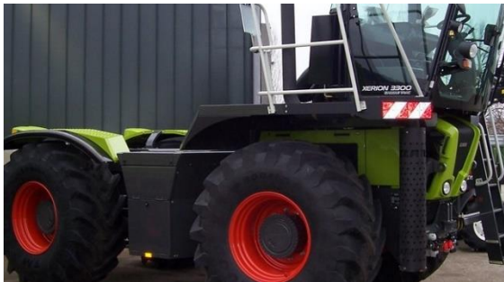
Abb. 13: Untersetzung in der Radnabe: Claas Xerion 3300 [13]
