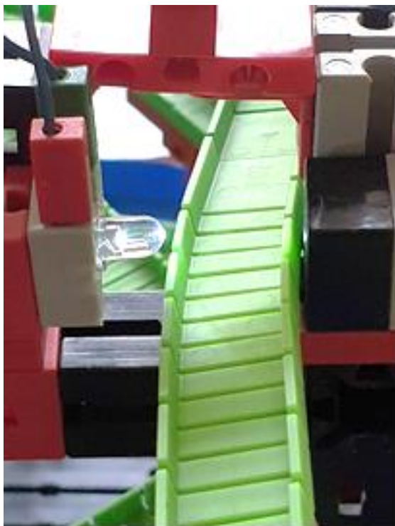
Abb. 1: Lichtschranke aus LED und Foto-Element mit Störlichtkappe
