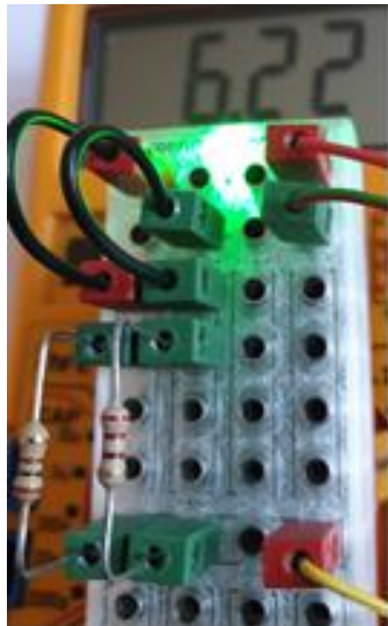
Abb. 16: Aufbau des Spannungsteilers
