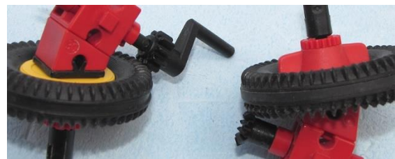
Abb. 7: Schiefwinkliger Antrieb von Reifen 45
