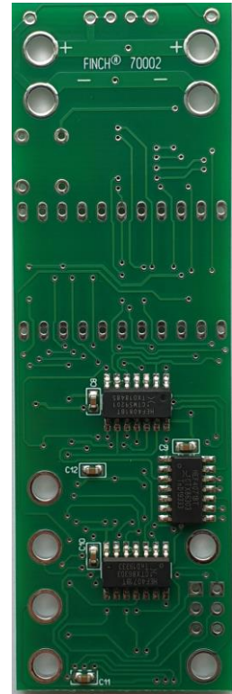
Abb. 10b: 70002 Bestückung Unterseite
