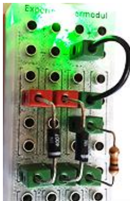
Abb. 18: Aufbau des ODER-Gatters
