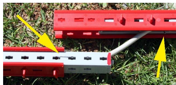
Abb. 10: Unter der Fahrbahn läuft ein serielle Kabel zur Bergstation gut versteckt, nur befestigt mit kleinen Drahtschlaufen. So verbindet man weite Wegstrecken zwischen Modellbereichen.
