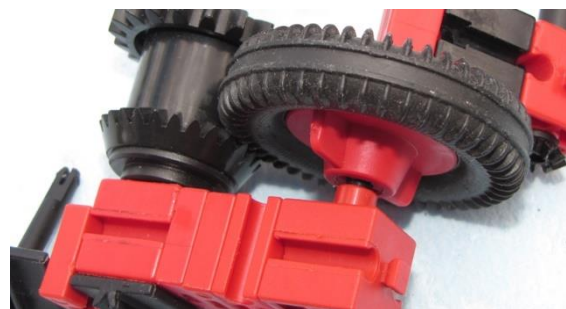
Abb. 8: Differenzialkäfig treibt Reifen 45
