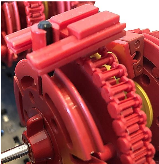
Abb. 14: Der Mitnehmer zur nächsten Drehscheibe
