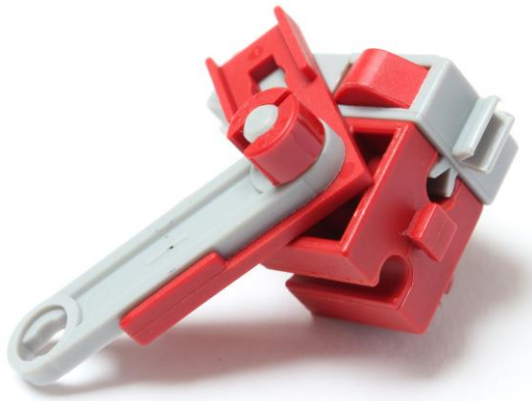
Abb. 10: Schalter mit Mini-Taster und langem Hebel; Konstruktion von Jeroen (23.11.2014)
