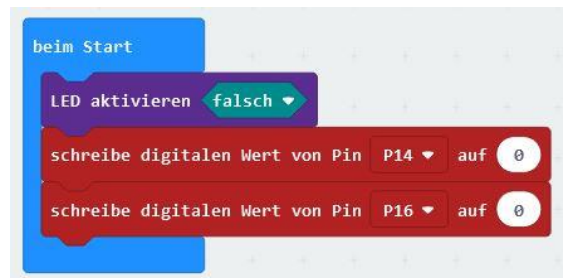
Abb. 5: Initialisierung der Ausgänge
