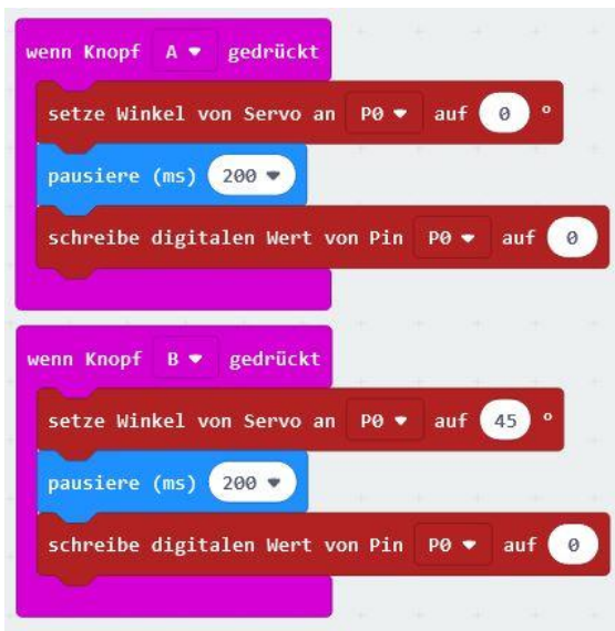
Abb. 11: Programmierbeispiel für einen Servo Über Knopf B wird der Servo um 45° bewegt. Mit Knopf A erfolgt der Weg zurück.
