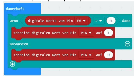
Abb. 8: Programmierbeispiel für die Abfrage von I1
