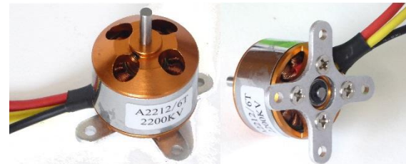
Abb. 27: Ein kommerzieller Außenläufer-Brushless-Motor
