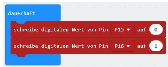
Abb. 7: Programmierbeispiel für M1 „rechts“
